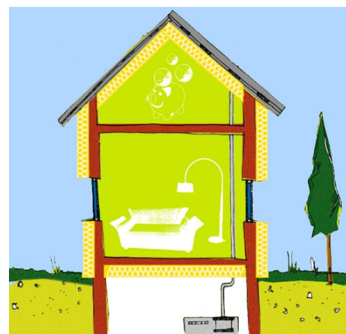
Passivhaus mit Dämmung
